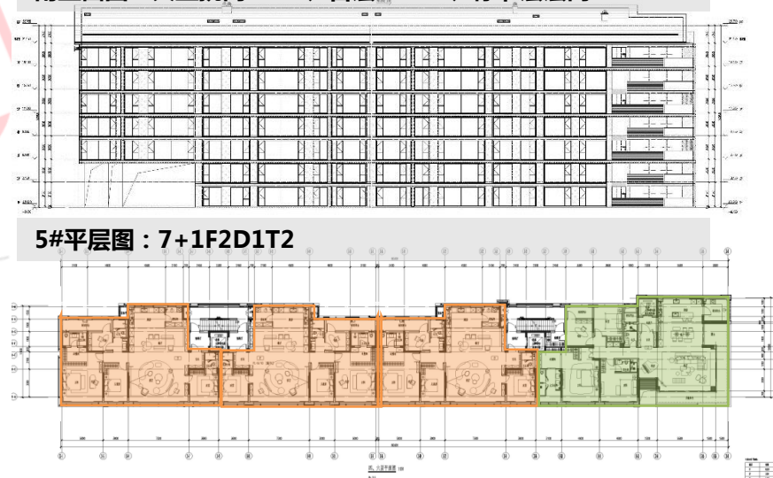
南立面图：大堂挑高6.2m、首层3.15m、标准层层高3.05m
